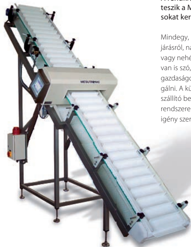
Ferde, emelkedő szállítószalagba integrált fémdetektor és fémszennyezett termék kifúvóval, árukiadás előtti ellenőrzéshez. Inclined conveyor belt with metal detector and air blast reject for the quality control
